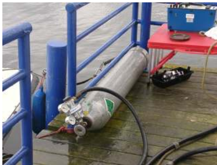
Ein normales DTG (50l) versorgt den Taucher mit der notwendigen Atemluft. Diese strömt permanent in den Helm des Tauchers.
