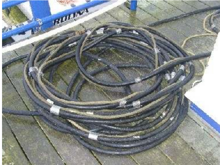
Hier sieht man den schwarzen Luftversorgungsschlauch (innen verstärkt mit einem Metallgeflecht), der mit der Sicherungsleine mit dem Taucher verbunden ist. In der Sicherungsleine ist das Sprechfunkkabel.
